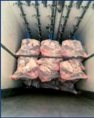
Semirremolques con ganchos. Especialmente diseñados para la industria cárnica, estos vehículos cuentan con más de 200 ganchos en la parte superior que permiten transportar grandes piezas de carne a temperatura refrigerada.
